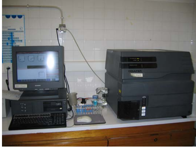
Şekil Ek B2. Coulter EPICS XL, ( Beckman Company. Miami, FL) hücre sayma cihazı görüntüsü
