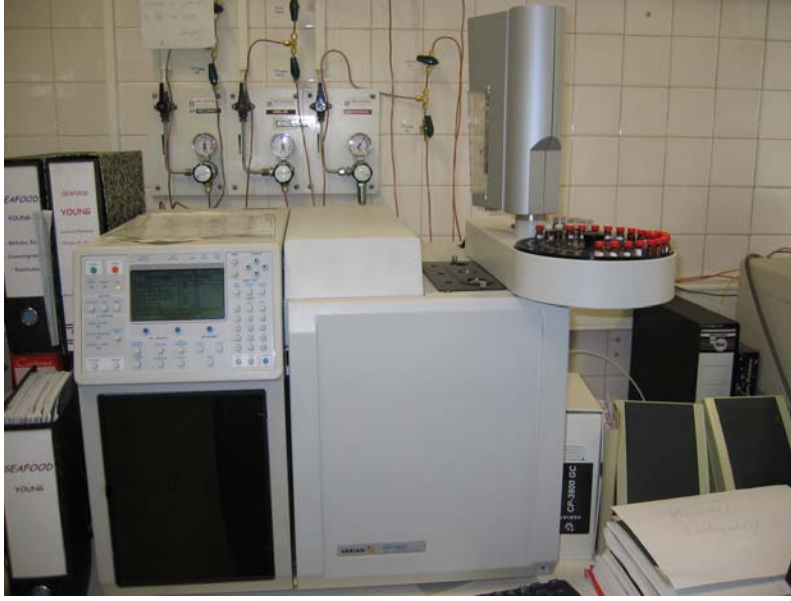
Şekil Ek B4 Varian Star 3800 Cx (Walnut Creek, CA) gaz kromatografisi görüntüsü
