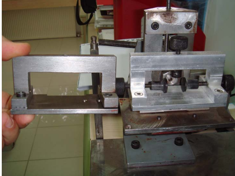
Şekil 10: Salıncak tablasının üzerindeki demir mengene (solda) sıklüsler sırasında ağırlığı nedeniyle basınçta dalgalanmalara neden olduğu için daha hafif olan alüminyum mengene (sağda) ile değiştirilmiştir.
