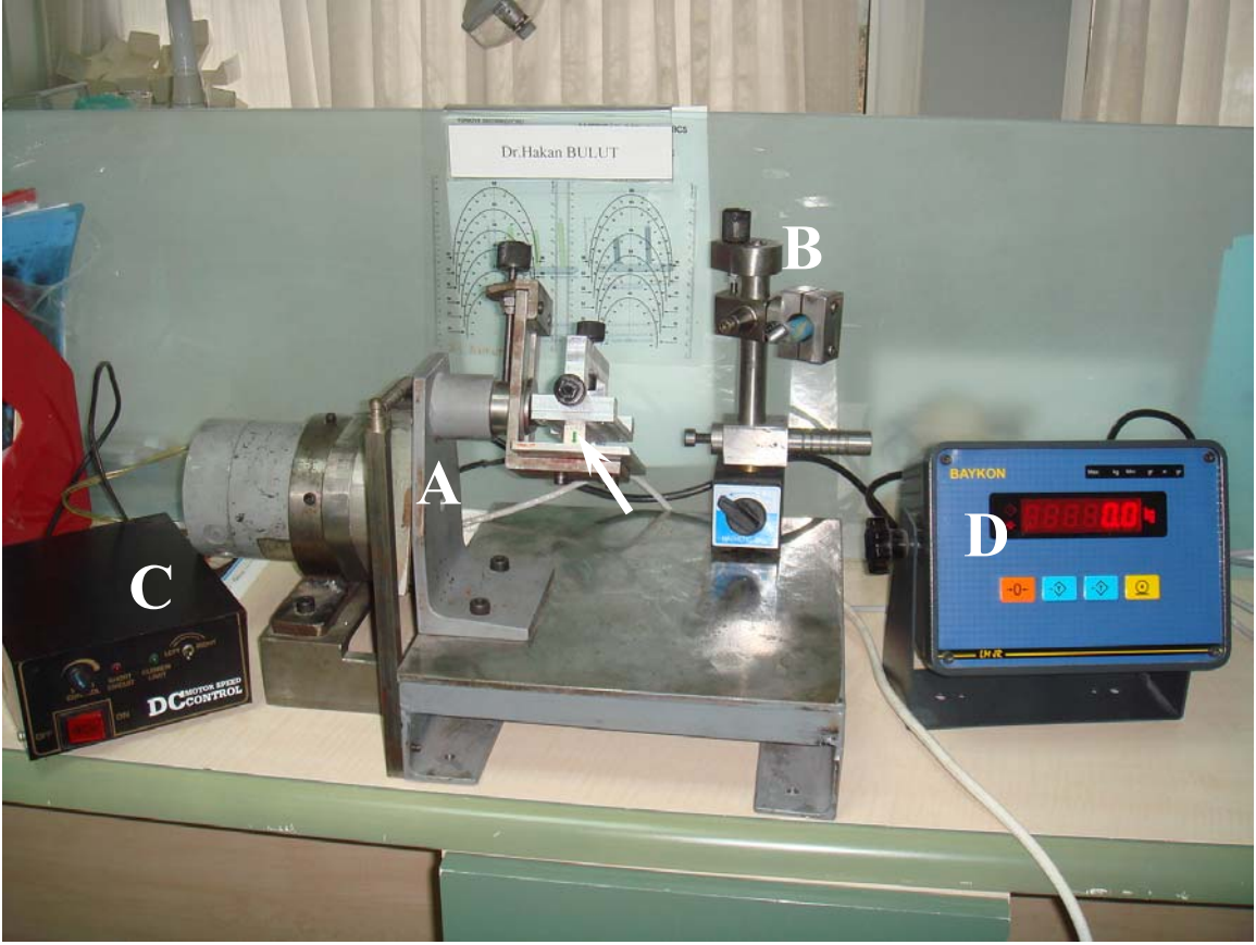
Şekil 6: Özel tasarlanan mekano-siklüs (mekanik salınım) cihazı. Soldan sağa: devir kontrol ünitesi; elektromotor ve ona bağlı salıncak; bağımsız ünite; LED-göstergeli ekran ve bilgisayar COM-bağlantısı (ok: mingenenin altındaki loadcell; tanımlar için metne bakınız).
