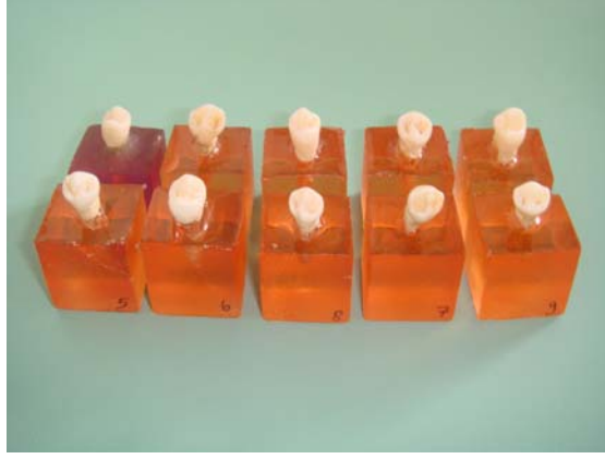
Şekil 2: Polyester kalıplara gömülmüş diş örnekleri.
