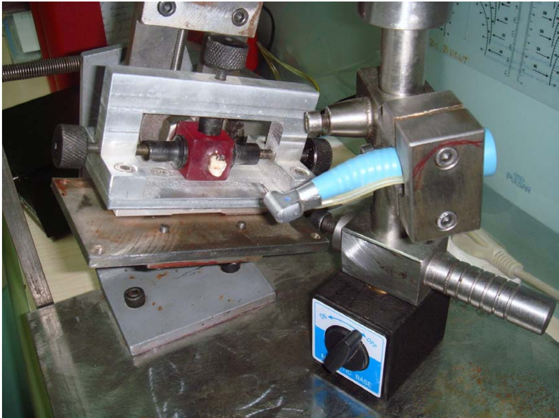
Şekil 12: Örneklerin braket tabanına paralel salınım yapması için salıncağın radial salınım açısının kalibrasyon işlemi.
