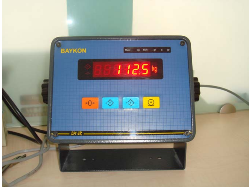
Şekil 8: LED-göstergeli dijital display sayısal rakamlara dönüştürülen verilerin eşzamanlı okumasını sağlamakta ve grafik çizimleri için verileri bilgisayara iletmektedir.
