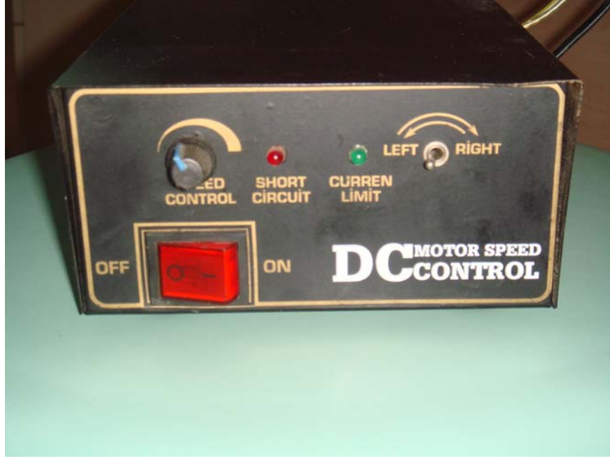
Şekil 7: Doğru-akım-elektromotorunun dakikadaki devir sayısını kademersiz ayarlayabilen ve sağ/sol dönme yönlerini kontrol eden elektronik ünite.
