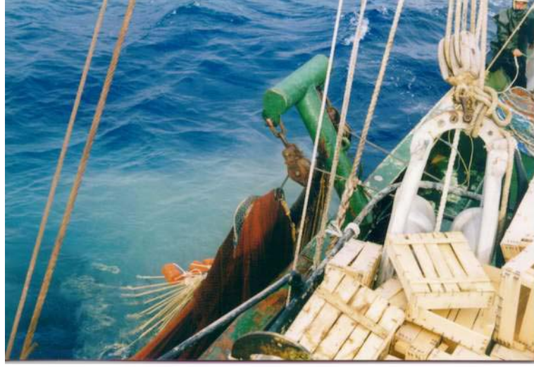
Şekil 8. İstinga halatının toplanması sonucu mapaların ve ağın bir kısmının mataforada toplanması
