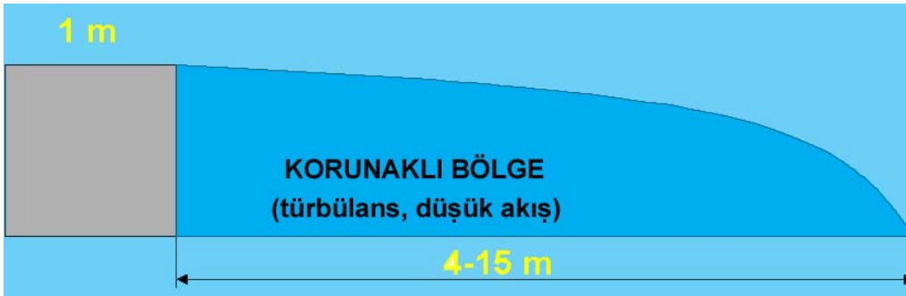
Şekil 3. Resif bloğu ve arkasındaki korunaklı bölge oluşumu
