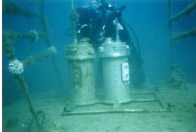
Şekil 6. Çok amaçlı oşinografi gözlem cihazının deniz zeminine montajı (Düzbastılar, 2001)
