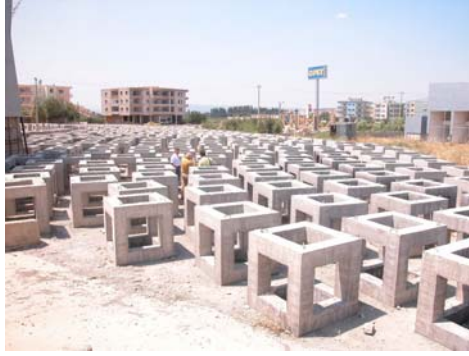
Şekil 20. Yapay resif uygulamalarında kullanılan beton bloklar
