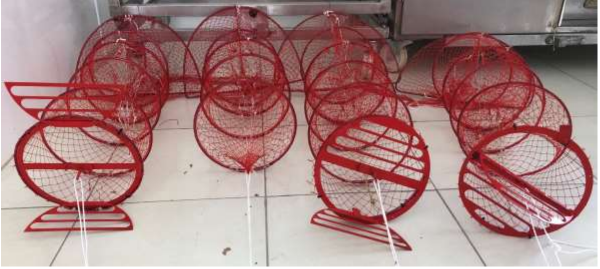
Şekil 3.2.8 Ergonomi denemesi için tasarlanan pinterlerin ve geleneksel pinterin donam sonrası genel görünümü
