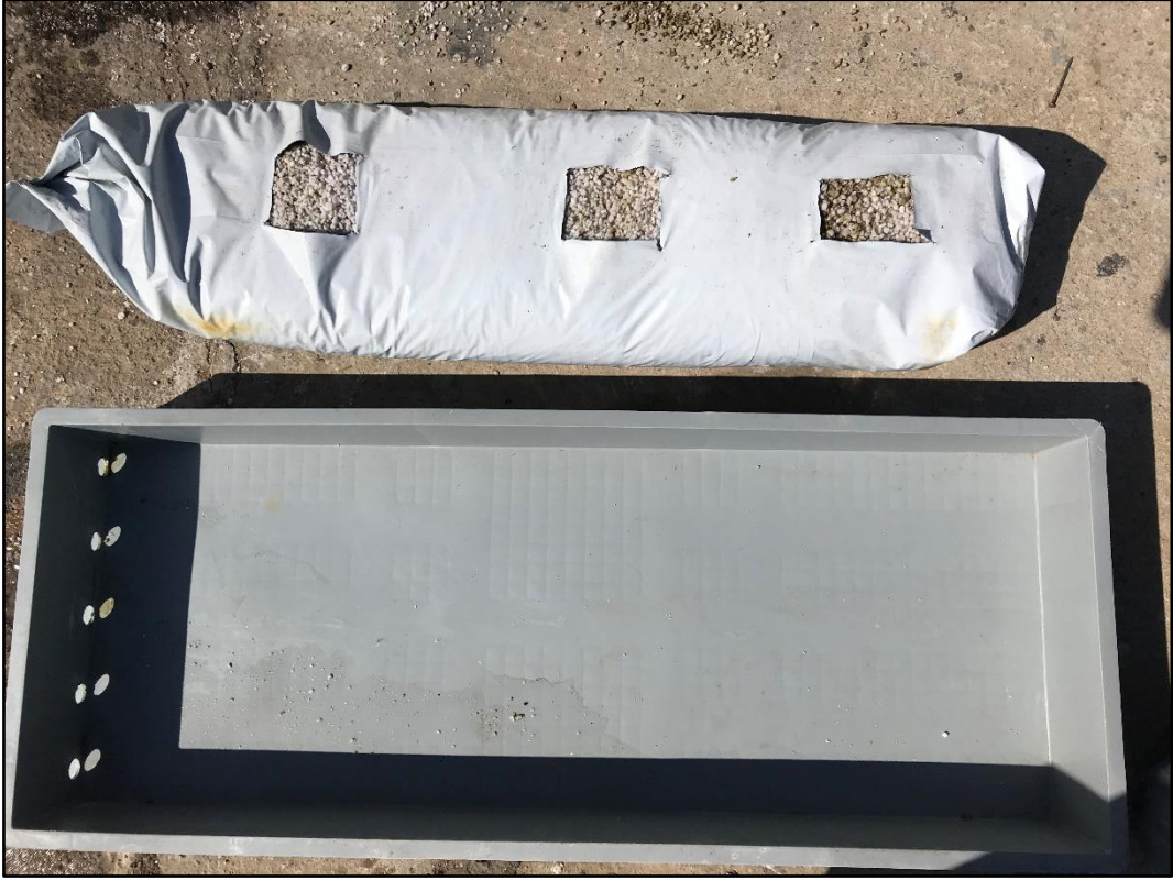
Şekil 3.5. Perlite dolu bigbag ve PVC bitki yatağı.
