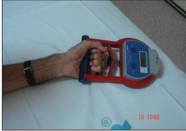
Resim 4: Dinamometre ile önkol ve el kavrama gücünün ölçümü
