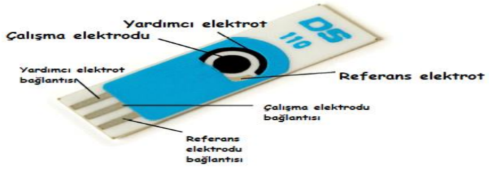
Şekil 8. SPE elektrodun bileşenleri
