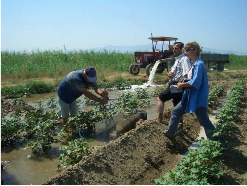
Şekil 3.6 Dikdörtgen kesitli savak ile akım ölçümü
