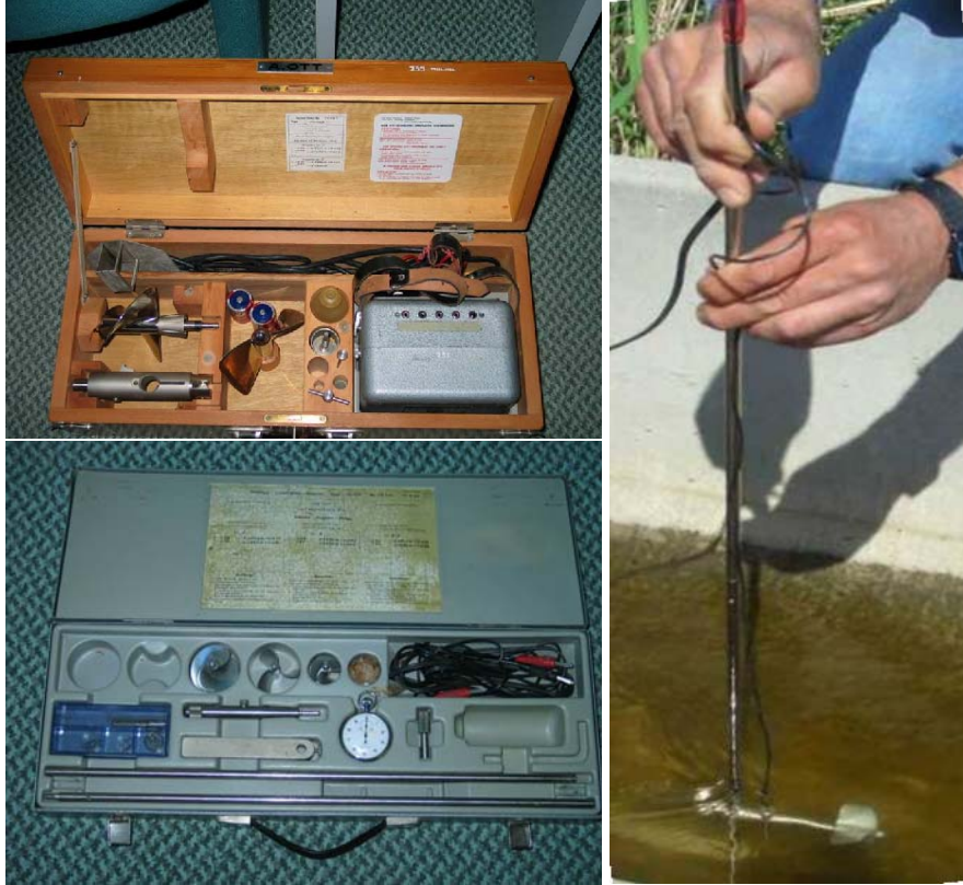
Şekil 3.7 Mulineler ve muline ile akım ölçümü
