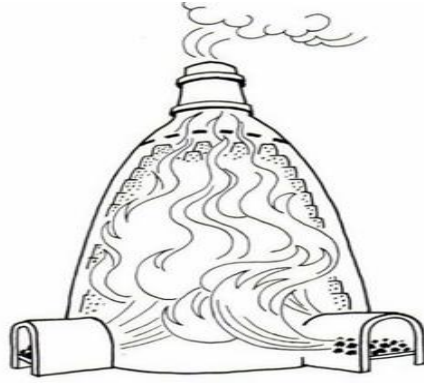
Resim 16: Üstten çekişli (Updraft). (Hamer ve Hamer, 2004: 373.)
