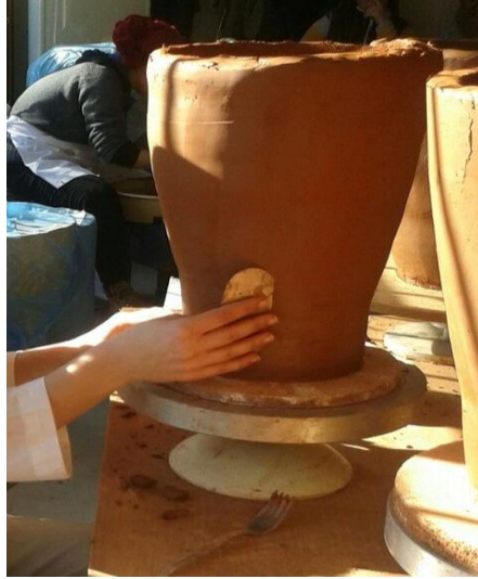
Resim 5: Çanak çömleğin yüzeyinin düzeltme işlemi. (Ece Ayrar tarafından çekilmiştir.)
