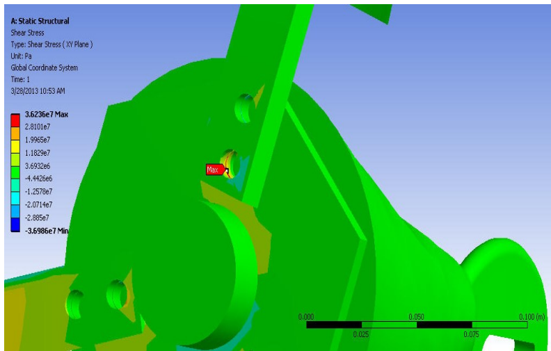
Şekil 8.54. Türbinde oluşan maksimum shear stress (Kanat bağlantı noktası: Çelik, Rotor göbeği: Çelik).
