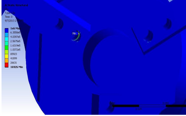
Şekil 8.126 400W'lık türbinin yorulma ömrü (Kanat bağlantı noktası: Ni-Ti, Rotor göbeği: Cu-Zn-Al).
