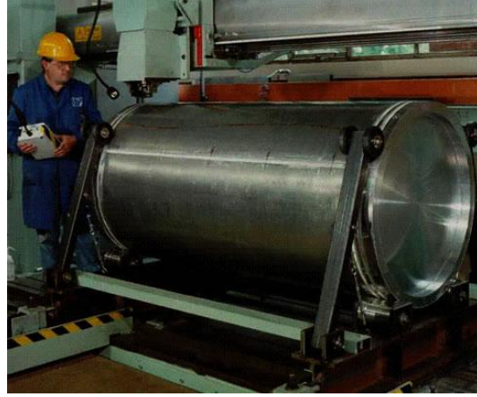
Şekil 6.11. Roket yakıt tankının laser kaynak işlemi (Hirsch et al., 2011).
