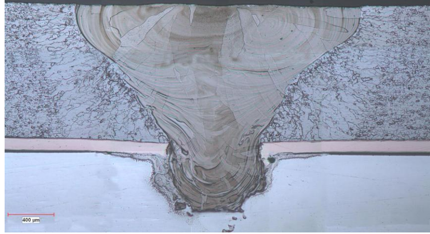
Şekil 9.48. 2600 W laser gücü ve 90 J/mm ısı girdisiyle bakır ara malzemeli yapılan birleştirmenin mikroskopik görüntüsü.
