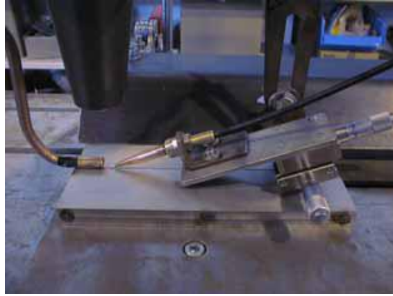
Şekil 3.4. Bir dolgu teli besleyicisinin laser kafasına bağlanmış görüntüsü. 1-laser kafası, 2-koruma gaz nozulu, 3-dolgu teli nozulu, 4-dolgu teli besleyici nozulu ayarlama tablası (Jokinen, 2004).
