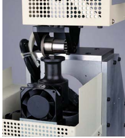
Şekil 4.8. Yatay Konumlandırılmış ve Dairesel Hareket Eden Horn (Altta) (Sonobond Ultrasonik Kaynak Makinesi Katalogları, 2007)
